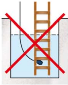
Kuva 4. Huomioi kellukkeen vapaa liikkuminen.
